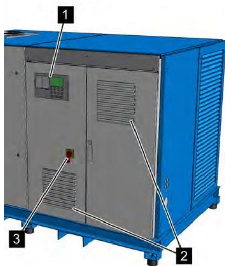
Рис. 11: Элементы управления и фильтр распределительного шкафа
