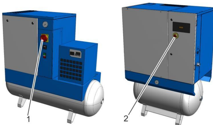
Рис. 1: Расположение предохранительных устройств
