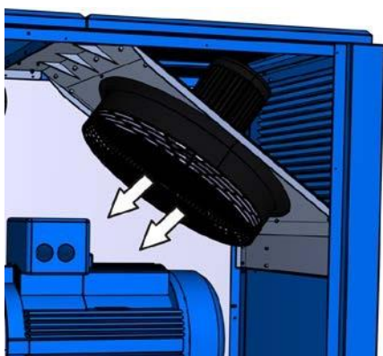
Рис. 25: Общая схема охлаждающего вентилятора
