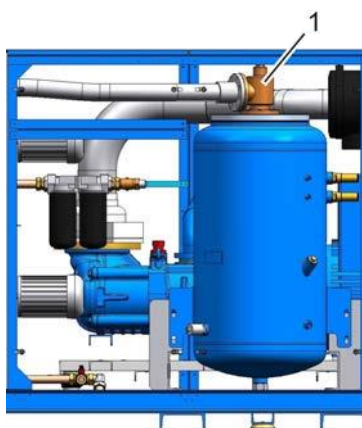
Рис. 18: Клапан минимального давления/обратный клапан
