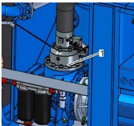
Рис. 32: Крепежные винты регулятора впуска (вариант)
